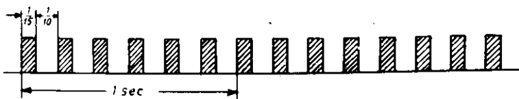
Bild 5. Tastzeichen des Haupteinflugzeichens Frequenz 38,0 MHz; Ton 1700 Hz
