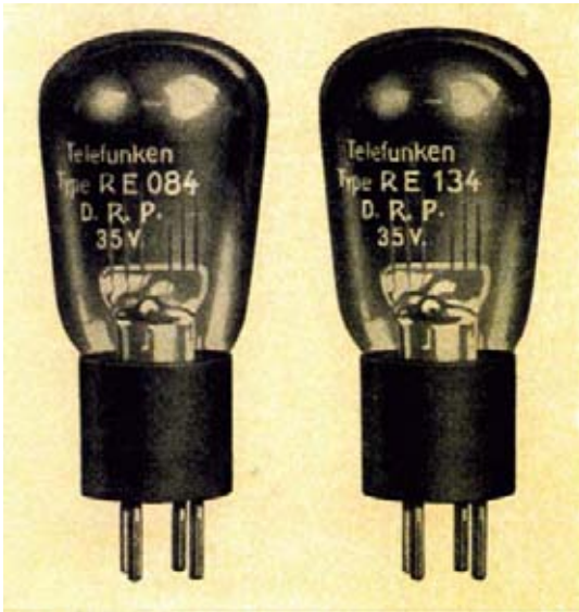
Bild 72. Rundfunkröhrentypen RE 084 und RE 134 mit nach dem Dampfverfahren hergestellter Kathode. Beispiele modernster Hochemissionsröhren, 30 und 50 Milliampere Sättigungsstrom.
