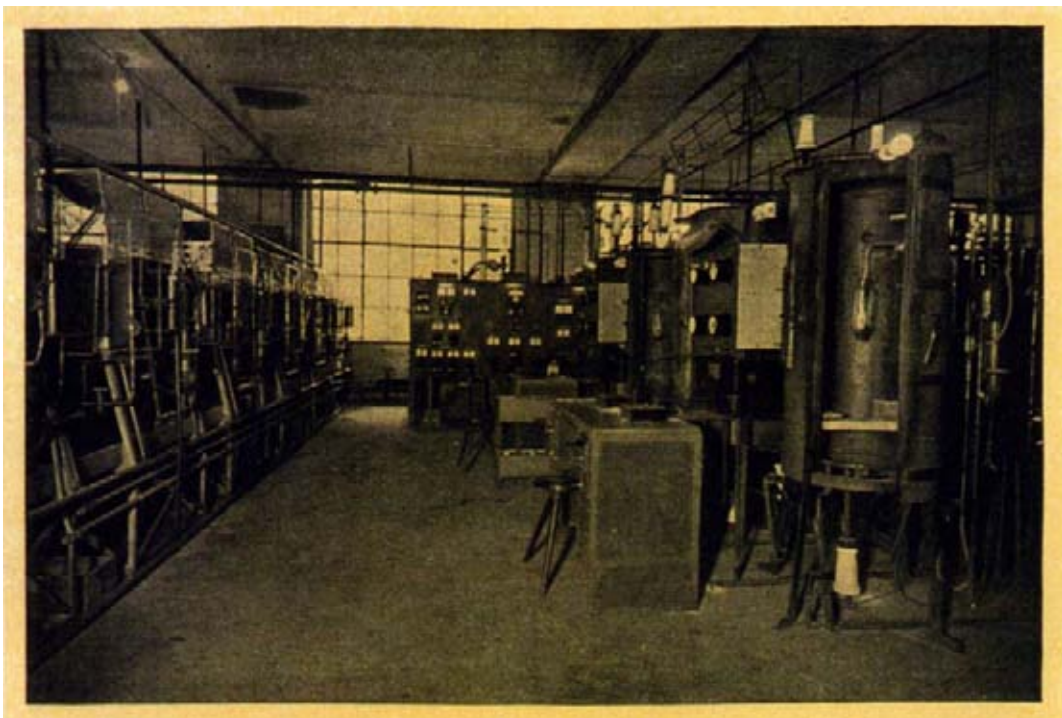
Bild 101. Die Herstellung von Telefunkenröhren im Osram-Werk A. Pumpstände für Senderöhren mit den großen hierzu notwendigen Evakuieröfen.
