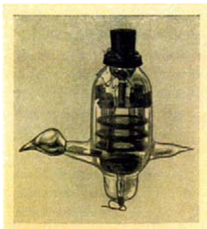
Bild 79. Glimmlichtverstärkeröhre nach Marx mit kalter Kathode, drei Steuerelektroden und Anode. Kaliumkathode und Edelgasfüllung nach Schröter.
