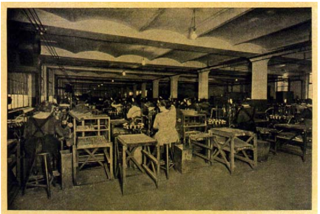
Bild 100. Die Serienfabrikation von Telefunken-Rundfunkempfangsröhren bei der Osram-Kommanditgesellschaft, Werk A, Sickingenstraße. Einer der Säle für maschinelle Einschmelzung der Elektrodenträger.
