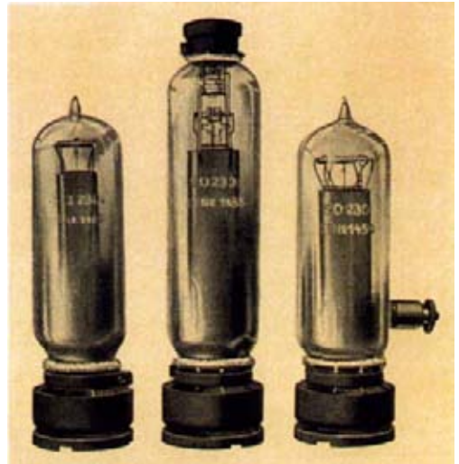
Bild 99. Senderöhren mit Sparfäden (Thoriumfäden) zur Verringerung des Heizwattbedarfs, für bis zu etwa 75 Watt Hochfrequenzleistung bei 1000 Volt Anodenspannung. Rechts: Zweigitterröhre für eine besondere Modulationsmethode.
