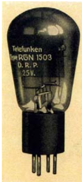
Bild 81. Hoch Vakuumröhre für Vollweg - Gleichrichtung RGN 1503; gibt mit zwei Einzel-Glühkathoden nahezu 75 Milliampere Gleichstrom bei 200 Volt Gleichspannung. Zur Lieferung von Anoden- und Gitterspannungen für Empfangsverstärker unter Benutzung des Wechselstromnetzes.
