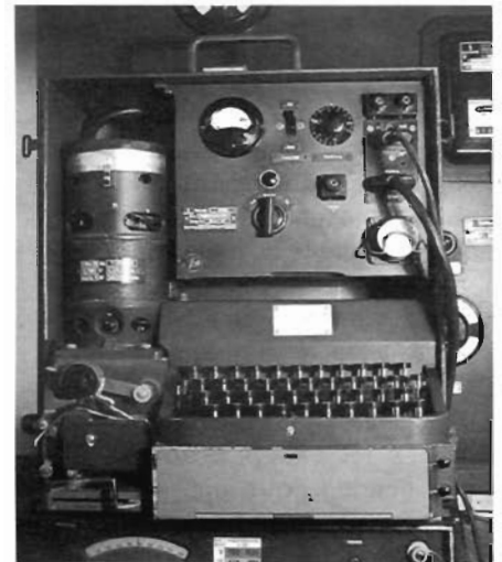
Figura 3 - A máquina Hellschreiber, completa, com a parte elétrica Foto: Helge Fykse
