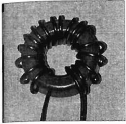
Bild 3: Die Verteilung von 16,5 Windungen auf fast dem gesamten Kernumfang des T94-2 führt zu einer Induktivität von 2,45 \mu H.
