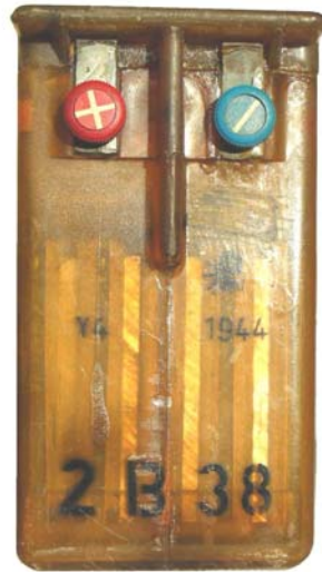
Abbildung 16: Kennzeichnung: Kurzbezeichnung „Y4“ Hersteller gemäß Tabelle 1: Fa. Varta
