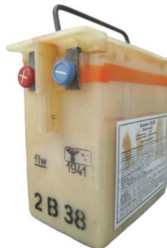
Abbildung 17 Kennzeichnung: Fertigungskennzeichen „flw“ Hersteller gemäß Tabelle 1 / 4/: Fa. A. Luscher
