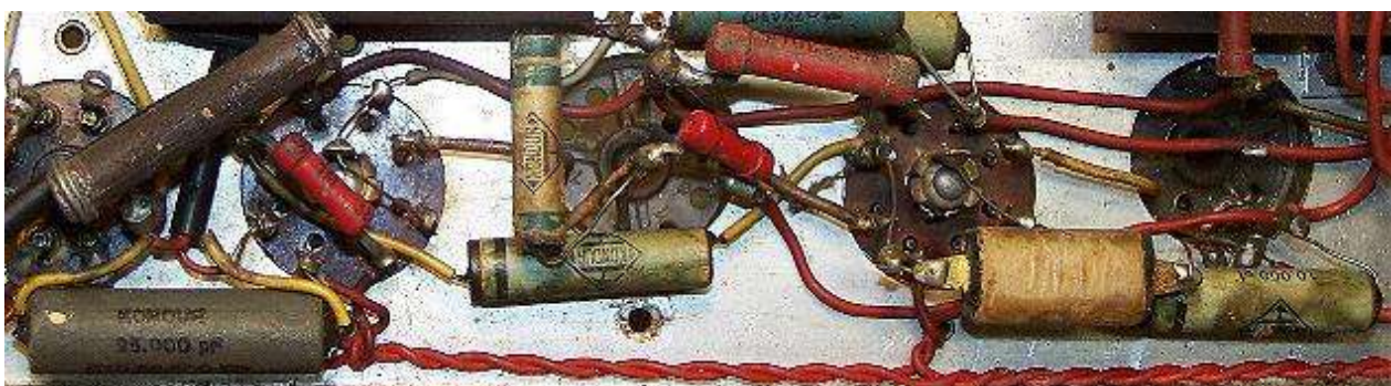
Blick auf die Verbindungen mit Hilfe von Lötzinn („fliegende Verdrahtung“, ZEHETNER Onyx, Baujahr 1949)
