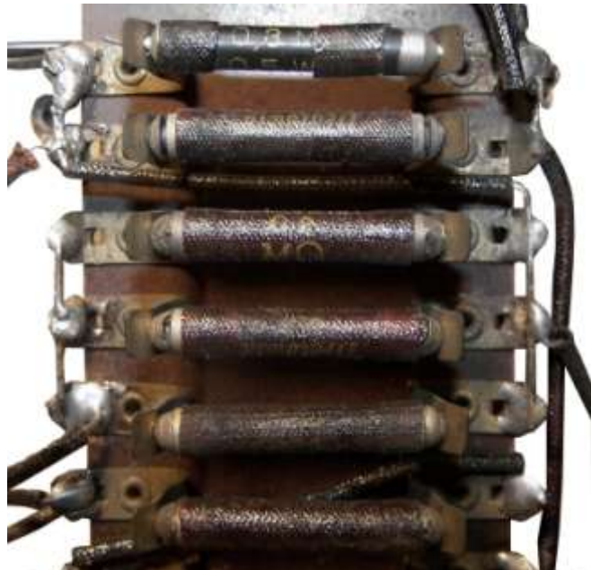
Typischer Schaltungsaufbau in Klemmtechnik (ca. 1933)
