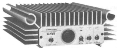
HL - 90v 430-440 MHZ - FM - SSB - (TV) GaAs FET - NF 0,8 dB Entrada 10W - Salida 90W (TV 60W) Previo recepción: 18 db
