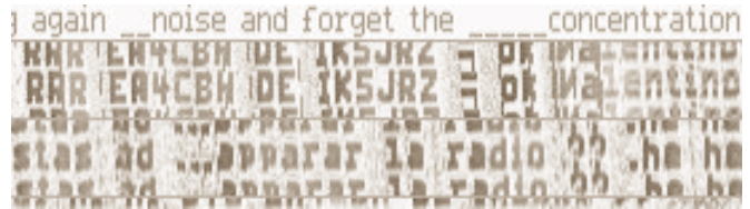
Figura 3: FH con un filtro de 80 Hz para eliminar interferencias (QSO con IK5JRZ).
