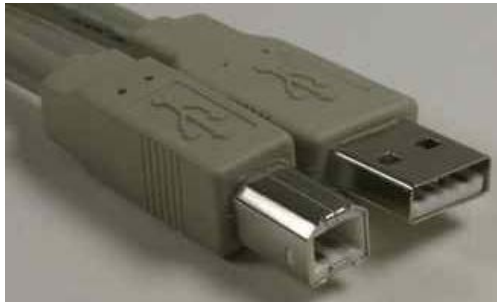
Das benötigte USB-Kabel zwischen PC und Interface: A-Stecker (links) auf B-Stecker.
