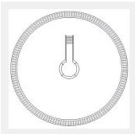
Lagerkonstruktion der Anlage mit Schienenkranz, Zugangsgraben und zentralem Lagergebäude (Schema ohne Massstab).
