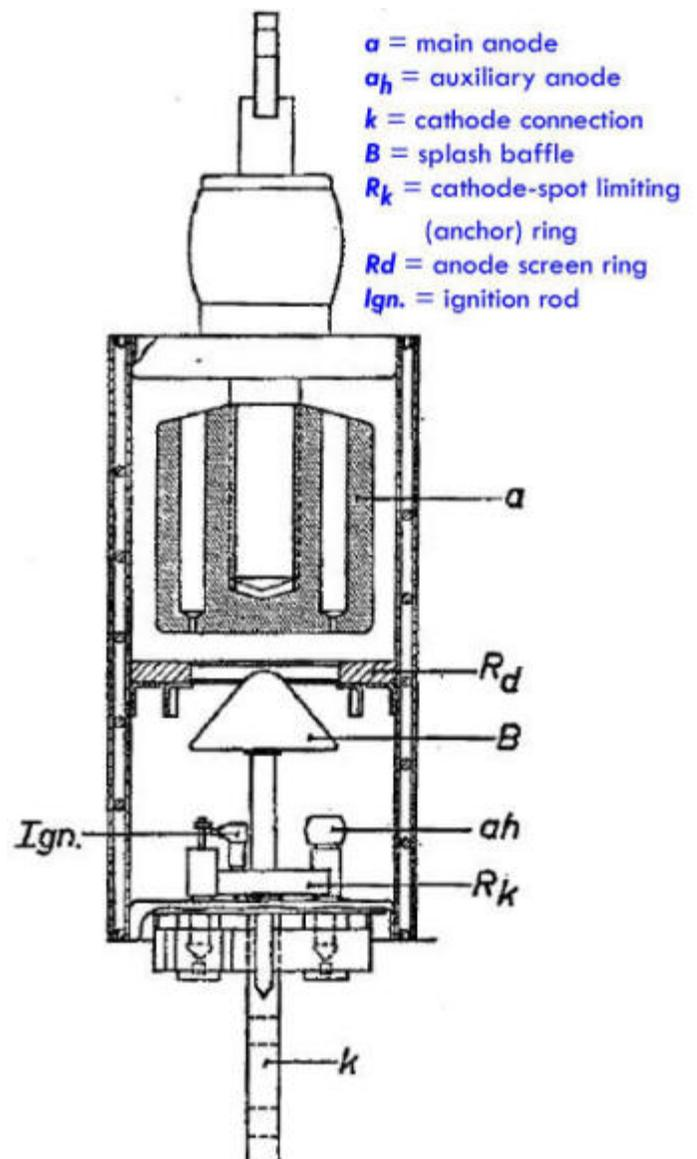
**Cross-section of a rectifier ignitron - type 5555**
