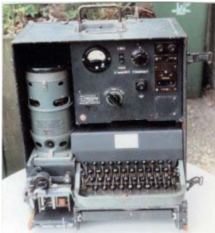
Obr. 2 Válečný „Feldfern-schreiber“ Siemens & Halske A2.
