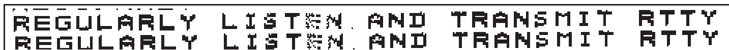
Obr. 6 ZL1ANY na 3,5 MHz – signál je přijímán programem, který rozlišuje jen černou a bílou barvu.
