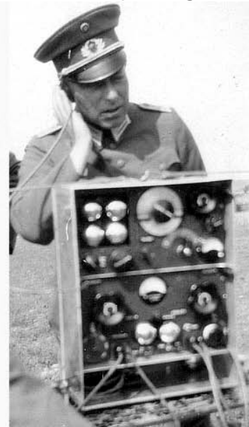
Ahemo 31. Die Fotos zeigen das Gerät bei der Vorführung vor ausländischen Besuchern im Beisein von Hauptmann Baltzer, 1931/32 Referent im Reichswehrministerium. Dieses Gerät könnte der Ahemo-Beitrag zur letzten und entscheidenden Entwicklungsstufe der Funksprechgeräte gewesen sein. Man sieht zwei Röhren im Sender und vier im Empfänger. Allerdings ragen bei
